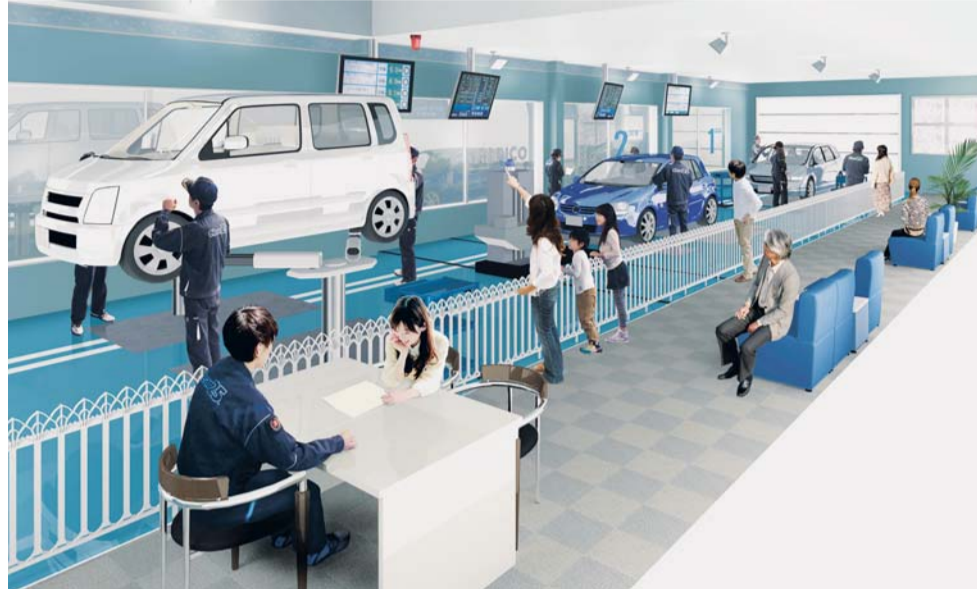
3ステーションシステム (特許第3977055号) 1日最大45台の車検が可能な車両検査システムだ
